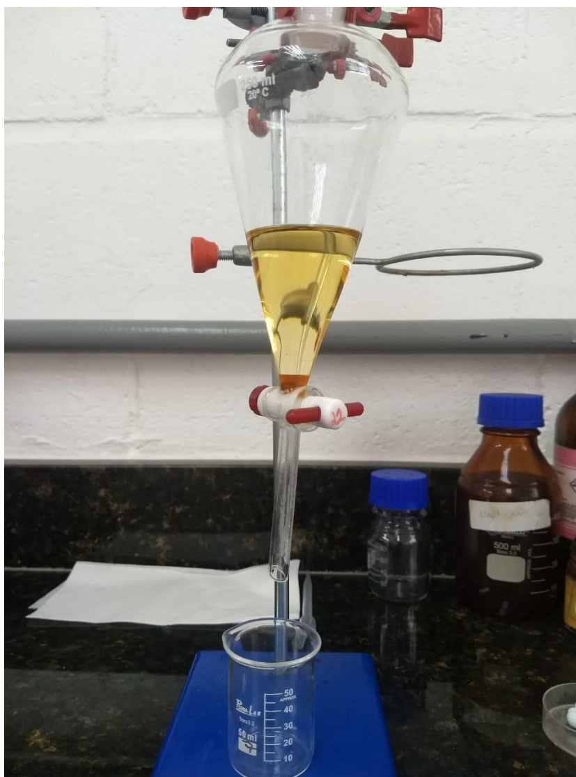
Figura 31 - Final da Decantação – Identificação das Fases
